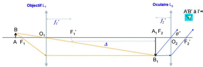
**L'objectif :** lentille du côté de l'objet, sa focale  $f_1'$  est petite, son rôle est de grossir l'image de l'objet pour former une image intermédiaire réelle et inversée.
