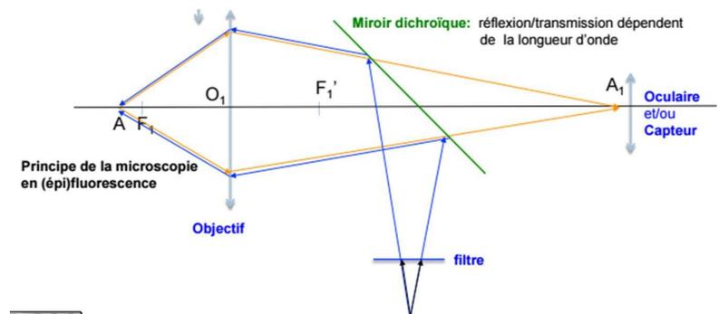
**Microscopie confocale à balayage laser :**
