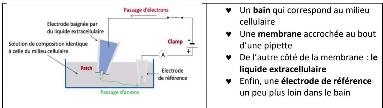
Entre la membrane patchée sur la pipette et l'électrode de référence, on peut observer le passage d'un **courant ionique osmotique**. Le **montage électrique** relie l'électrode de référence à l'électrode comportant la membrane. On va donc pouvoir étudier la **conductance** de la membrane et voir si l'on a des surprises...
