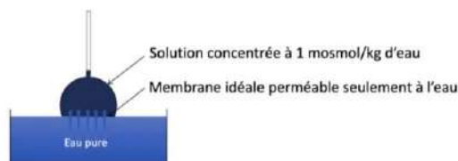
Flux d'eau du secteur le moins vers le plus concentré (en osmoles).
