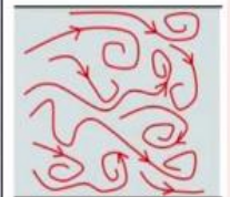
Plus de répartition parabolique des vitesses \rightarrow témoigne d'un flux turbulent dans cette aorte
