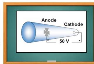
Mais ils se sont aperçus que si **on réduisait la pression atmosphérique**, à partir de **10<sup>-2</sup> atm** on observait des **décharges électriques**. Ils n'étaient pas capables de comprendre ce phénomène, mais ces décharges électriques sont dues à un **flux d'électrons qui va de la cathode vers l'anode**.
